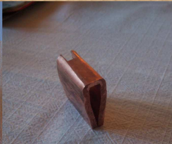
Die Aussparung für den Munemachi ist eingebracht.
